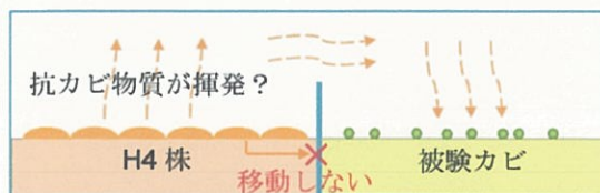
図10 実験8での2分割シャーレの断面図 抗カビ物質は培地中を移動できないので、揮発した時のみ効果を示す
