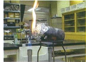
写真4：炭の作成 実験装置
